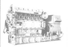
**BRAND-NEW** DAIHATSU DIESEL Model 6PSHT-26H 660BHP 720RPM 260×320mm Air Start MITSUBISHI GENERATOR Model CFC-DP AC450V 550KVA 60Hz 3 €
