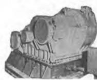
**DOUBLE INPUT—SINGLE OUTPUT DIESEL REDUCTION GEARS**
