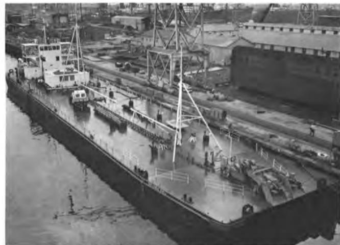
**SELF-PROPELLED BUNKERING BARGE**
