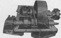
G.E. AUX. TURBO-GEN. REDUCTION GEARS
